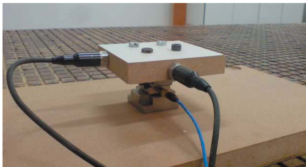
3. ábra: Rezgémérő műszer munkadarabra rögzítése
