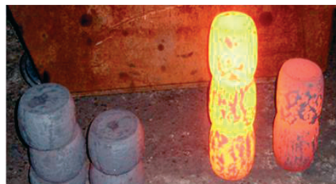
5. ábra. Üzemi körülmények között zömített kovácsdarabok.
