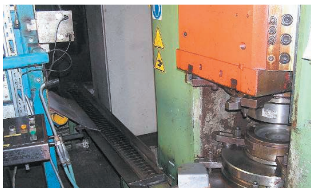
4. ábra. Vaccari gyártmányú 10NS típusú frikciós prés
