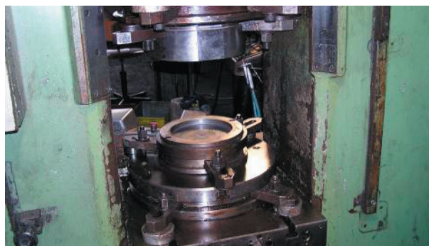
5. ábra. A használt zömítőszerszám
