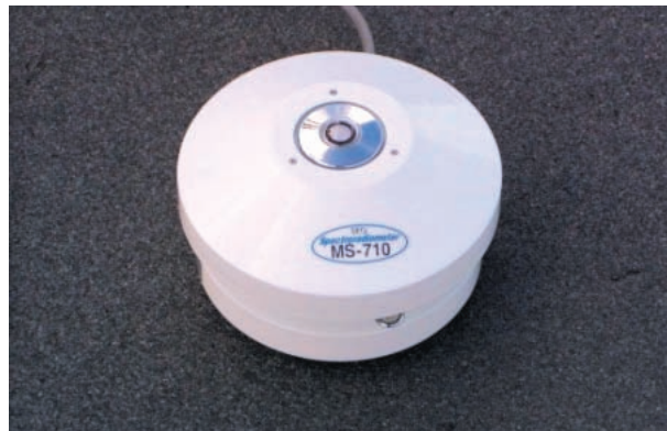
7. ábra. A használt MS-710 spektrométer
