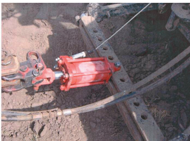
2. ábra. A vonóerő mérésére szolgáló hidraulikus munkahenger elhelyezése
