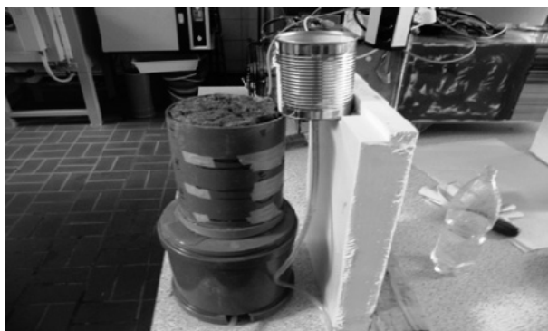
1. ábra. A talajoszlop vízzel történő telítése
