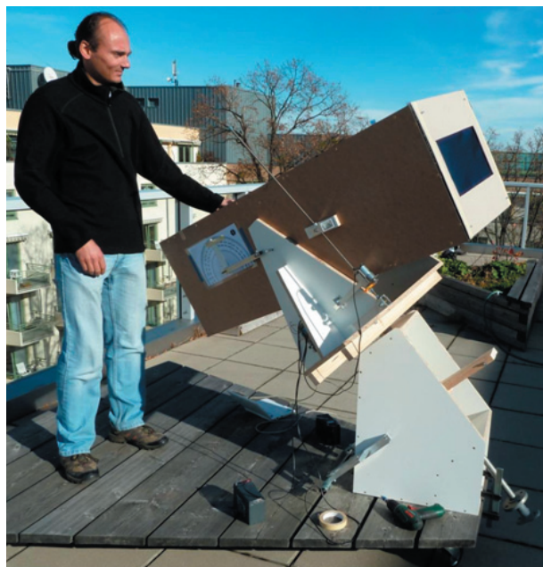
11. ábra. A spektrális függés mérésére kifejlesztett berendezés
