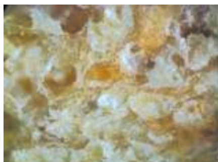
9. ábra. A búzaliszt hozzáadásával készült tálca mikroszkóp alatti hosszirányú metszete (40 X-es nagyítás)
