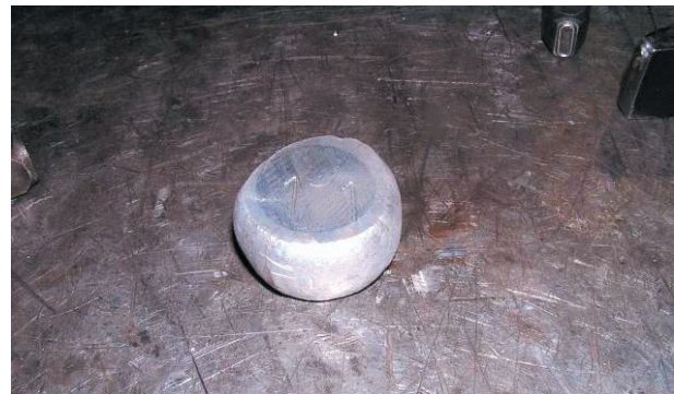
1. ábra. Süllyesztékes kovácsolással gyártott próbatest
