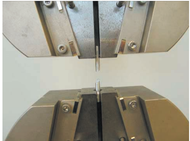
10. ábra. A próbatest szakítás után
