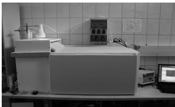
4. ábra. Hungarocellel körülzárt talajoszlop kísérlet
