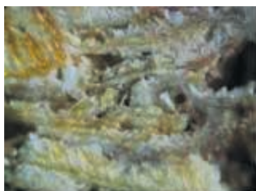
7. ábra. A szalma hozzáadásával készült tálca mikroszkóp alatti metszete (40 X-es nagyítás)
