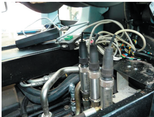
4. ábra A tengelykapcsolók vezérlőnyomásainak mérése szervizcsatlakozón keresztül
