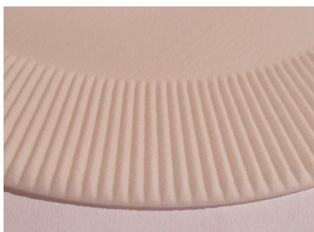
10. ábra: SLS technológiával gyártott fogazat
