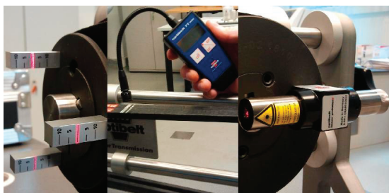
4. ábra: A lézeres geometriai, és az előfeszítés beállítás
