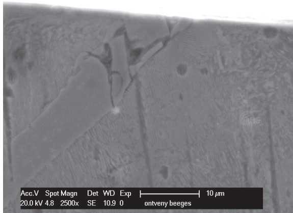
9. ábra. SEM felvétel: A felszín alatti réteg grafit szemcséjének összetöredezése
