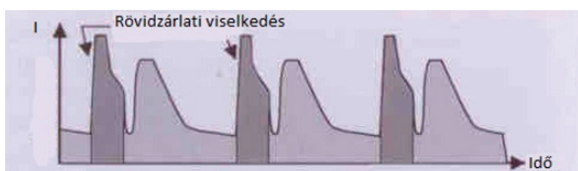
4. ábra. Áramimpulzussal segített cseppátmenet [2]
