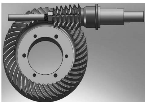
1. ábra: Tányérkerék megmunkálásának CAD modellje a közvetlen mozgásleképezés elve alapján
