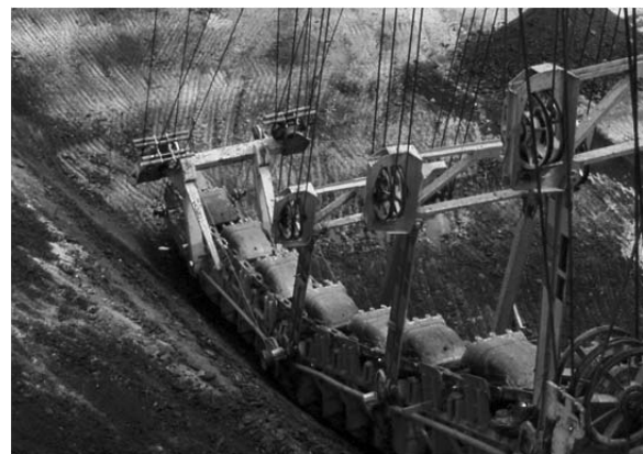
1. ábra. Forgácsképek a jövesztett felületen a régi merítékekkel
