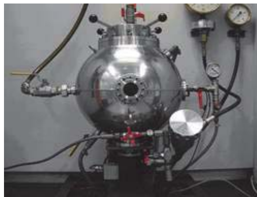
Por- és gázrobbanás vizsgáló cella
