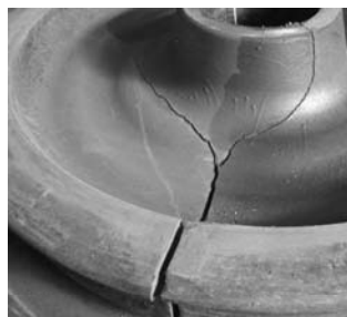
1. ábra: A koszorútól a kerékgagyig átrepedt kerék
