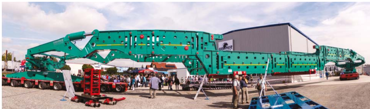
5. ábra: a Greiner GmbH cég impozáns 500 t-ás kombinált ollóemelő szállítóhídja
