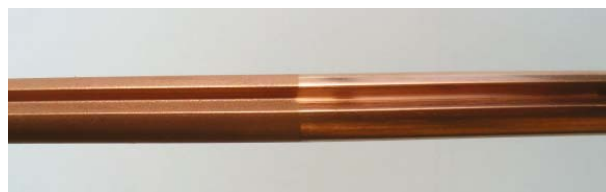
1. ábra. A felületkezelt és nem felületkezelt AC100 munkavezeték.
