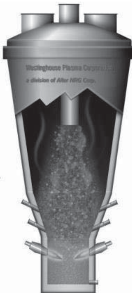
1. ábra: Harmadik generációs plazmareaktor elvi felépítése és működése [Westinghouse Plasma Co.]
