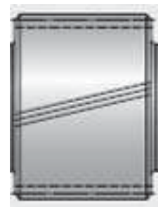
4. ábra: Fogaskerék ábrázolása fogazat egyszerűsítéssel
