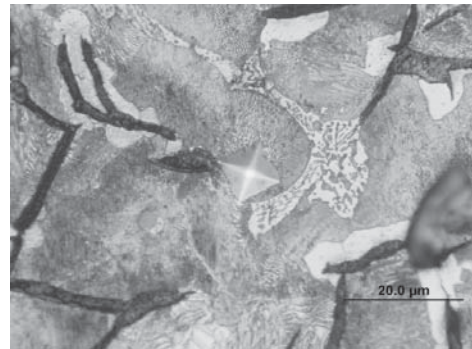
4. ábra Első mérési sorozat 9. mérési pontja foszfidos eutektikum környezetében
