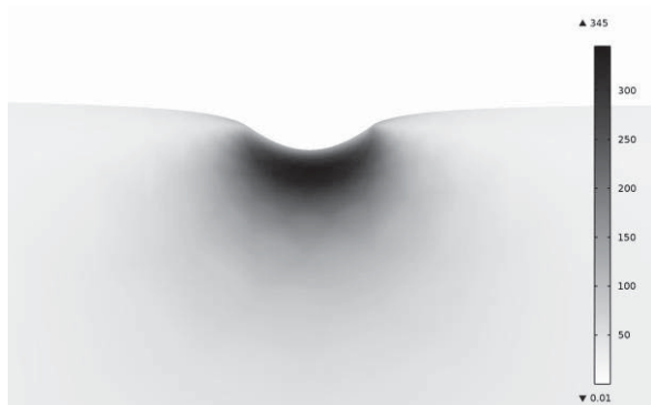
11. ábra A szilárd testből a szimmetriasík által kivágott keresztmetszeten ébredő Mises feszültség eloszlása
