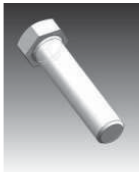
1. ábra: Csavar 3D ábrázolása menet egyszerűsítéssel
