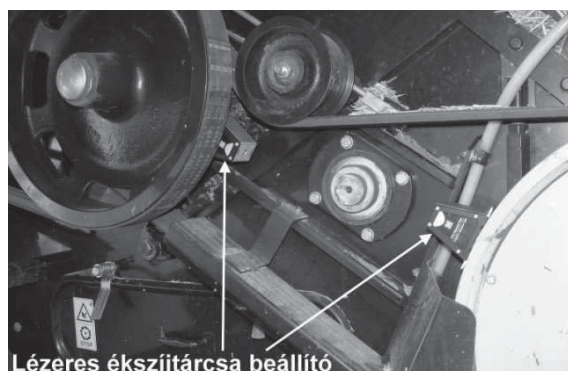
1. ábra. A gabonabetakarító gép ékszíjhajtás-elrendezése, beállítási hibák vizsgálata
