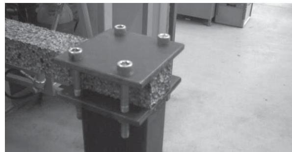
5. ábra A próbatest rögzítése
