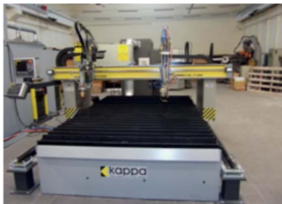
CNC vezérlésű láng- és plazmavágó berendezés
