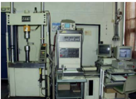
MTS 810 típusú elektrohidraulikus anyagvizsgálógép
