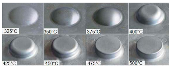
7. ábra: Különböző hőmérsékleteken végzett alakítások eredménye [5]
