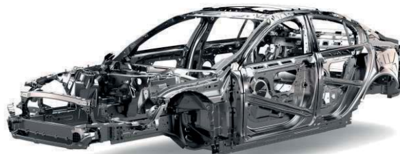
1. ábra: Jaguar XE alumínium lemezből készült karosszéria (Jaguar Land Rover Ltd.)
