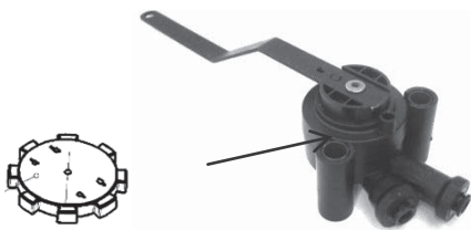
4. ábra. Kerámia betétes, részvezérlésű szintállító szelep összehegesztett műanyag ház-felekkel
