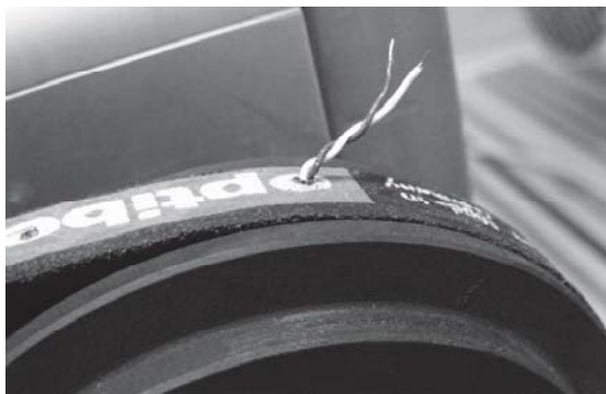
6. ábra Ékszíjba beültetett hőelem
