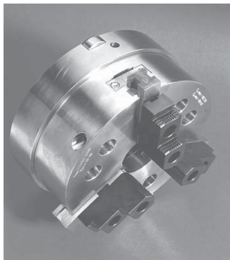
Automatikus pofaléptetésű tokmány (SZIMIKRON Kft.) Vásári Nagydíjat nyert Budapesten a MACH-TECH-en 2003-ban
