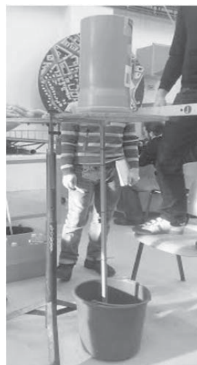
3. ábra MÉRŐBERENDEZÉS A VISZKOZITÁS MEGHATÁROZÁSÁRA
