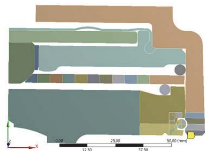
7. ábra. A ház megfogása X és Y irányban
