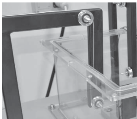
6. ábra. A súlyerő segítségével működő terhelőrendszer konstrukciós kialakítása
