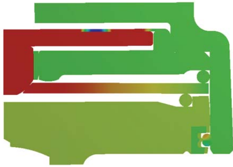
2. ábra. A mérlegszelep felterheléskor
