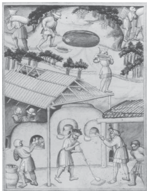
1. ábra: Egy középkori erdei üvegműhely ábrázolása. Bemutatja a különböző üvegyártási tevékenységeket: a háttérben a fából készült hamut égetik és elszállítják[1]
