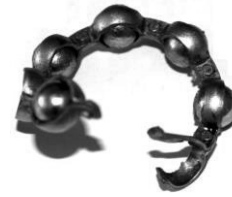
5. ábra. A kosárszerkezet károsodása
