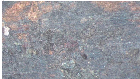
1. ábra Mikroszkópos felvétel a féktuskó súrlódó felületéről: a) szélső rész, b) középső rész.
