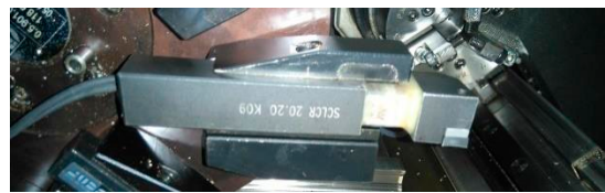
4. ábra A nyúlásmérő bélyegekkel ellátott kés a késtartóban elhelyezve
