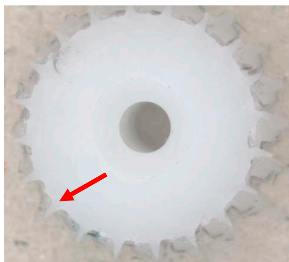
3. ábra. Az egyik károsodott csigakerék mikroszkópos képe (8x nagyítás)
