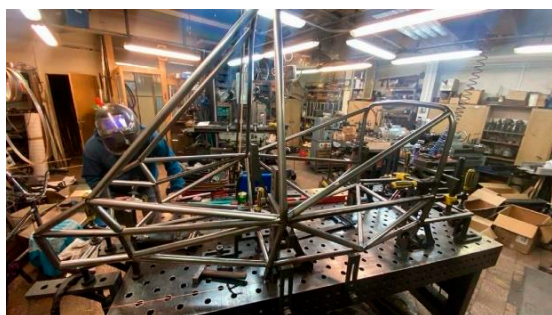
8. ábra Legyártott csőváz
