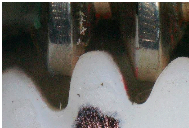
9. ábra. A beépített csigakerék
