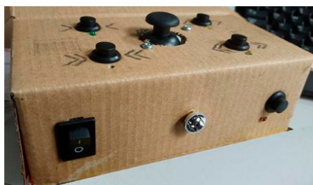
1. ábra IR kommunikációs távirányító [2]
