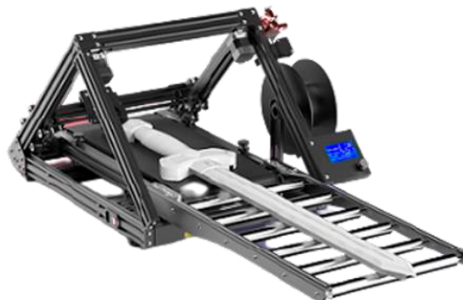
3. ábra. Szalagos 45°-os elrendezésű 3D-nyomtató.
