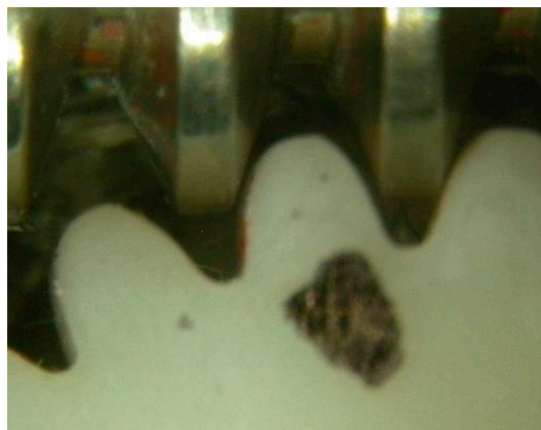
10. ábra. A profiletolásos csigakerék
