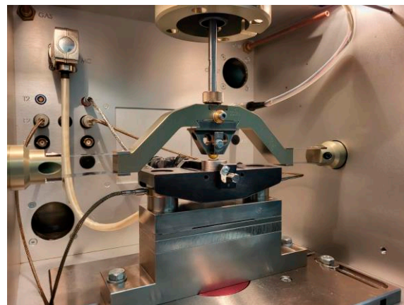
3. ábra Koptatóvizsgálat az Optimol SRV5 tribométerrel
