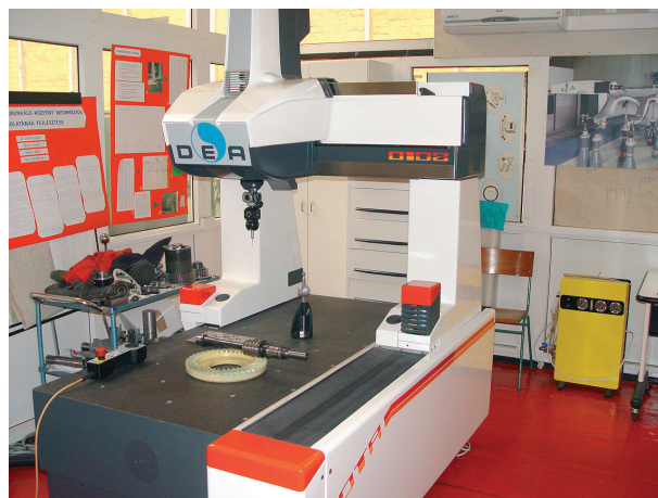
1. ábra – DEA típusú 3 koordinátás mérőgép
