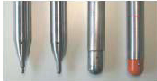
4. ábra. Különböző bélyeg kialakítások inkrementális alakításhoz
