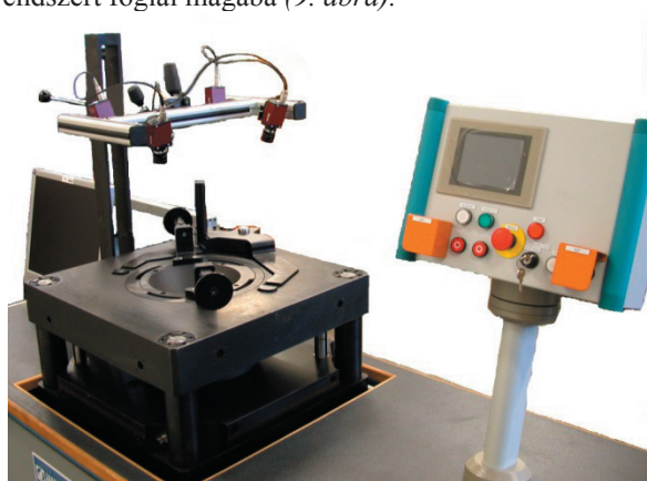
10. ábra. Az alakíthatósági vizsgáló rendszer és az optikai mérőrendszer fényképe
