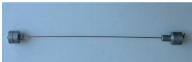
8. ábra. A szakító próbatest a felfűzött betétekkel
