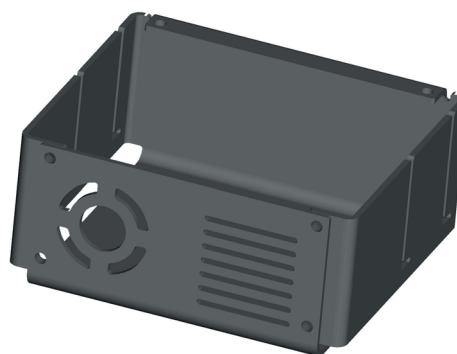
2. ábra. Hajlított lemez gyártmány
