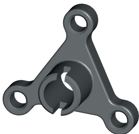
1. ábra. Forgácsolt gyártmány modellje
