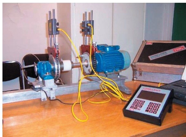
2. ábra Az U-500 rezgésdiagnosztikai próbapad (1993)
