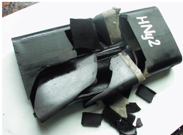
4. ábra. Polimer mátrixú kompozitból készült tetőtartó elem nyomóvizsgálat után.
