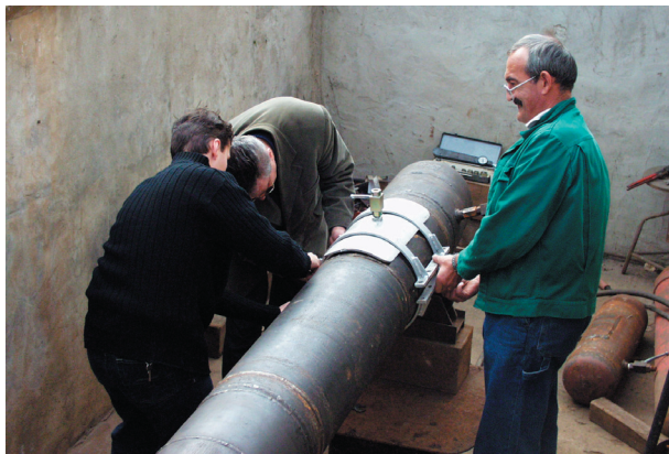
5. ábra. Csővezeték lyukadás időszakos javítására szolgáló csőbilincs (In memoriam Balogh Gábor)
