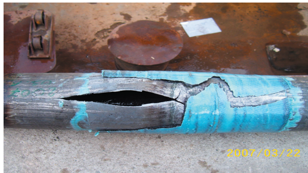
1. ábra. Polimer mátrixú kompozittal megerősített hibrid csőszakasz fárasztó- és repesztő vizsgálat után.
