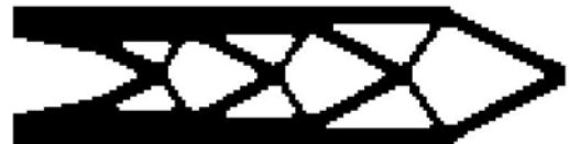
5. ábra. BESO megoldása (181,4 Nmm; 200(33))
