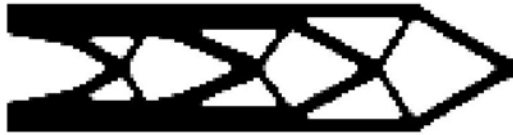
7. ábra. QSQF megoldása (182 Nmm; 200(52), pcw.) V_0=0,55 ; ER=1,5\% ; H_s=0,5 ; H_d=0,5 (it.<30); \beta=4,5,6\dots
