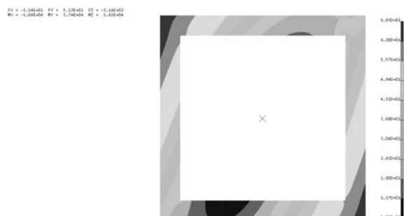
10. ábra. A redukált feszültség eloszlása a 2 jelű keresztmetszeten
