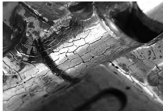
2. ábra Hőfáradási repedések kovácsoló-szerszámon
