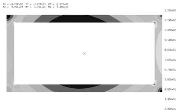
11. ábra. A redukált feszültség eloszlása az 5 jelű keresztmetszeten
