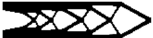
6. ábra. QSQF megoldása (181,3 Nmm; 200(31), pcw. ), V_0=0,55 ; ER=1,5\% ; H_s=0,5 ; H_d=0,5 (it. <30); \beta=4,6,8\dots
