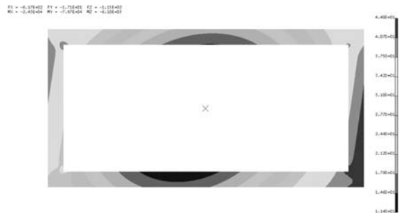
9. ábra. A redukált feszültség eloszlása az 1 jelű keresztmetszeten
