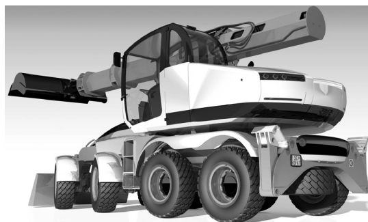
Fig.1 Telescopic excavator SUS Scrofa
