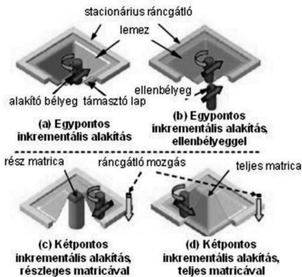
7. ábra. Az inkrementális lemezalakítás négy alapesete
