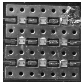
1. ábra. 3x3 LED modul fényképe
