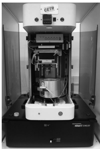
6. ábra. Az UNMT-1 moduláris mikro-nano felületvizsgáló berendezés körmozgást megvalósító tribológiai vizsgálatokhoz alkalmas modulja 350 °C-ig fűthető kamrával felszerelve
