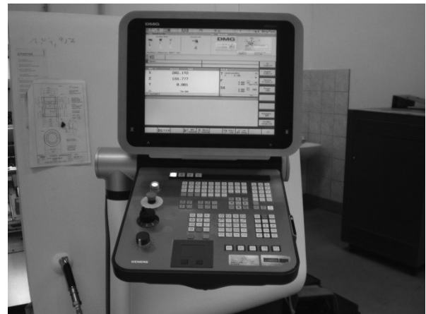
2. ábra Sinumerik 840D vezérlő
