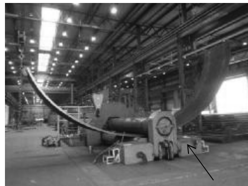
1. ábra. A nagyteljesítményű hengerítő berendezés hengerítés közben
