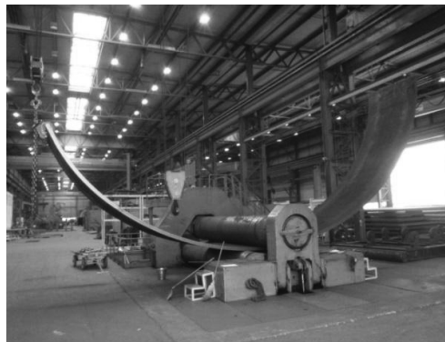
1. ábra. A nagyteljesítményű hengerítő berendezés hengerítés közben
