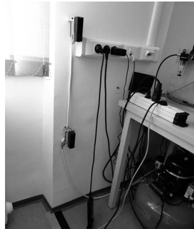
7. ábra. A munkaterét védő fénysorompó két optikai szenzora
