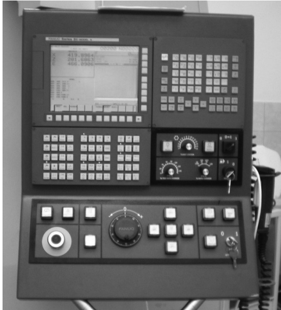
6. ábra Fanuc 31i vezérlő
