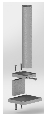
2. ábra. Ejtőtár felépítése
