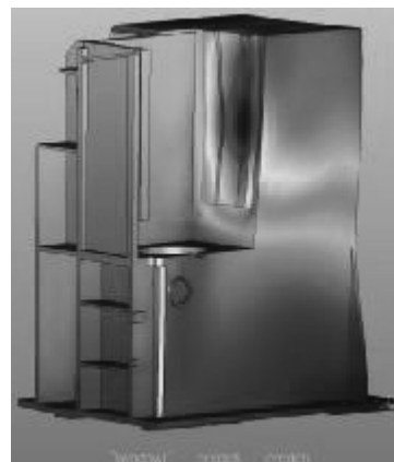
8. ábra. Az eredeti állvány elmozdulás mezője
