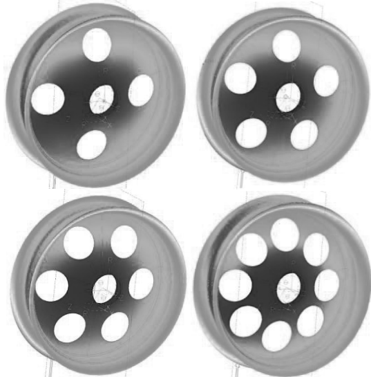
6. ábra. A keréktárcsa héjszerkezetének elmozdulásai négy-, öt-, hat- és nyolc küllős esetben.
