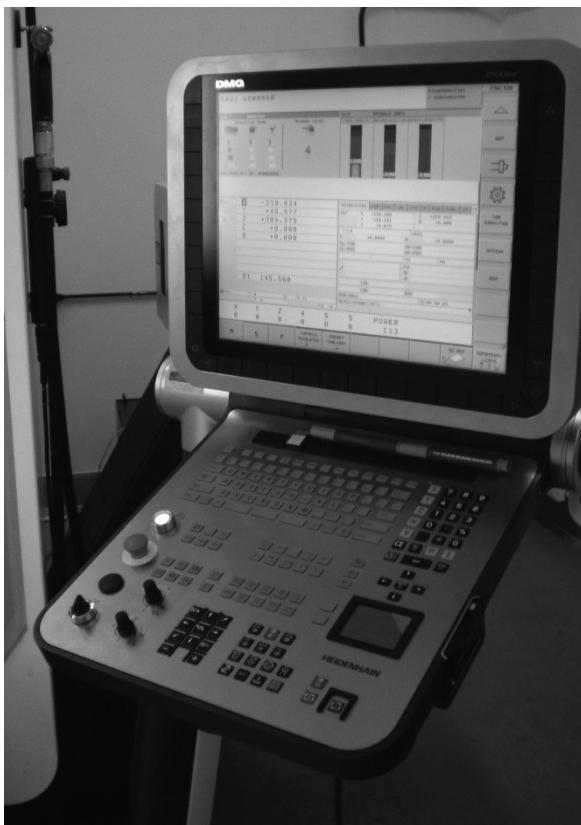
4. ábra Heidenhain iTNC530 vezérlő
