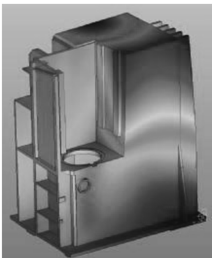
11. ábra. A merevített állvány elmozdulás mezője
