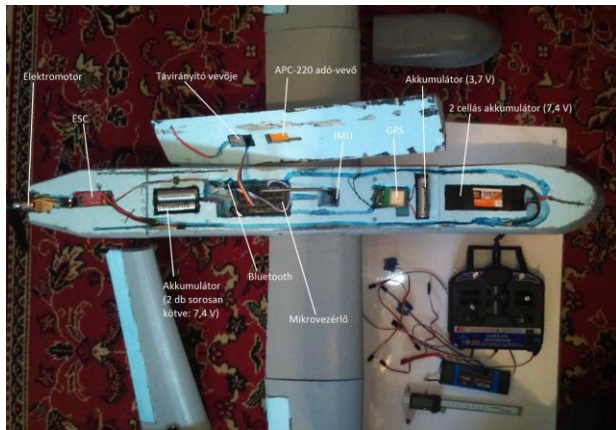
2.3. ábra: Beépített elektronika és megvalósított elrendezés
