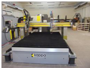
CNC vezérlésű láng- és plazmavágó berendezés
