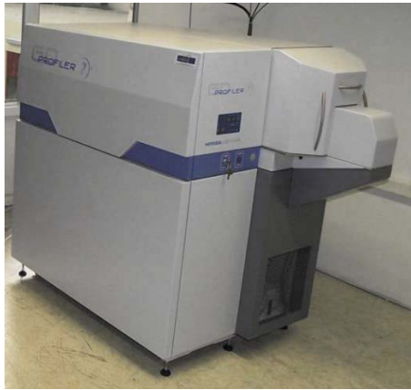
9. ábra. A vizsgálatnál alkalmazott GDOES berendezés
