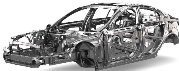
1. ábra: Jaguar XE – Az első teljes alumínium karosszériás felső-közép kategóriás személyautó
