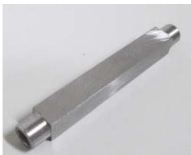
3. ábra. A hőhatásövezet szívósságának vizsgálatára alkalmas Gleeble próbatest fényképe
