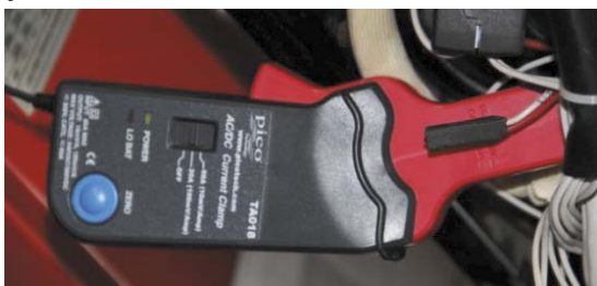
4. ábra. A motor áramfelvételének mérése és rögzítése
