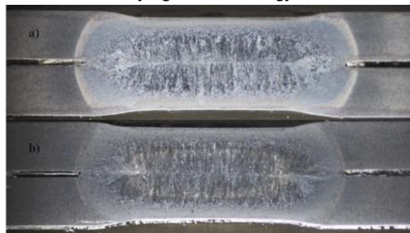
7. ábra. DP 1000-es acél a) folyamatos energiabevitelű és b) szimmetrikus kétimpulzussal ponthegesztett kötése
