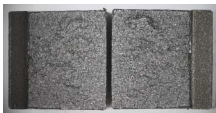
6. ábra. A furatos ütő próbatest ridegen tört felülete
