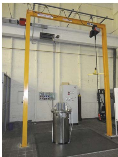
A plazmanitridáló berendezés a kiszolgáló sánderuval
