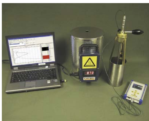
2. ábra. Az ivfSmartQuench műszer és részei
