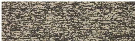
5. ábra. DP 1000-es alapanyag szövete képe. Nagyítás: 500x, Marószers: Nital (világos: ferrit, sötét: martensit)
