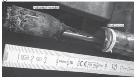
6. ábra Az 1. termikus mérés során előállított szilárd halmazállapotú erőteljesen átalakulatlan polisztirol alapanyag
