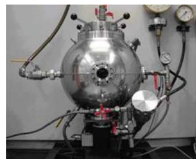
Por- és gázrobbanás vizsgáló cella
