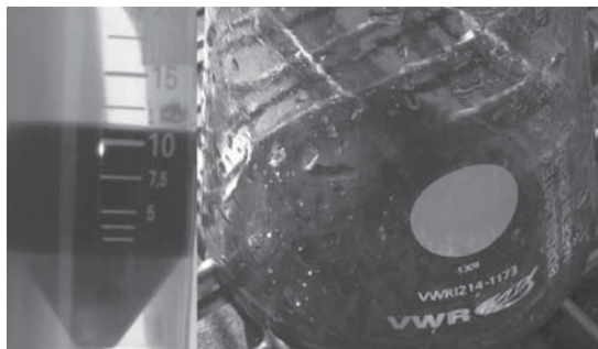
5. ábra A 2. termokatalitikus mérés során előállított folyadék halmazállapotú szén-hidrogén termék
