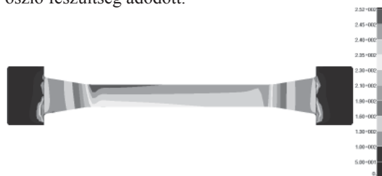
5. ábra Húzóterhelés hatására kialakuló feszültségmező az alapváltozat esetében (MPa-ban).
