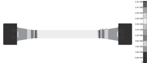
8. ábra A próbapálcán kialakuló von Mises redukált feszültség (MPa-ban)
