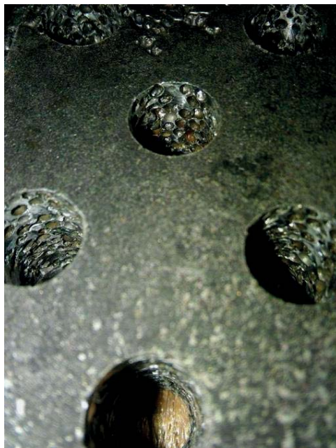
b) furatok kilépő oldalai belső hűtés-kenés alkalmazásakor
