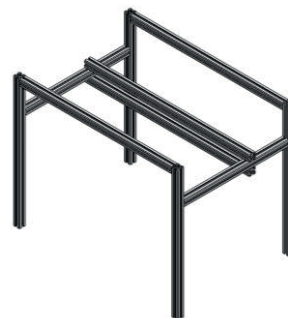
2. ábra Az alapkeret koncepciója előformázás illetve manipulálás vizsgálatához.
