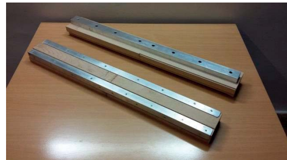
18. ábra. Az elkészült fényezővályú és a présforma alulnézetben. Jól láthatók az alumínium erősítések
