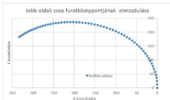
4. ábra. A jobb oldali csap furatközéppontjának elmozduláspályája
