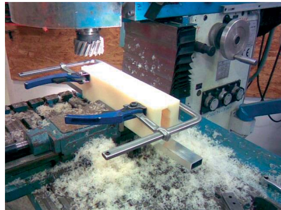
13. ábra. A fényezővályú elemeinek megmunkálása egytetemes marógépen
