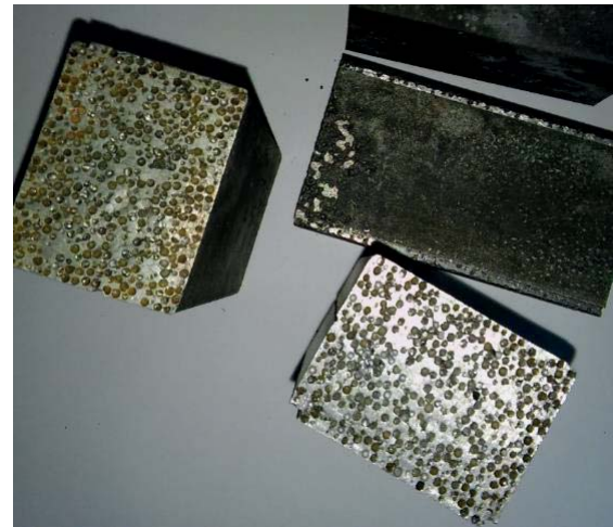
1. ábra. Fűrészi kísérletre előkészített munkadarabok
