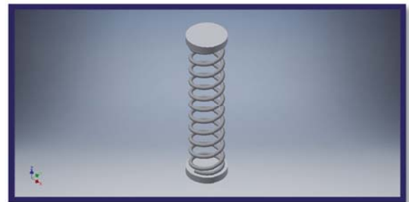
3. ábra. Körszelvényű hengeres nyomó csavarrugó
