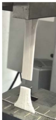
6. ábra Állított pozícióban nyomtatott próbatest, mely egyenletesen, a réteg mentén elszakadt, jelentős kontrakció nélkül
