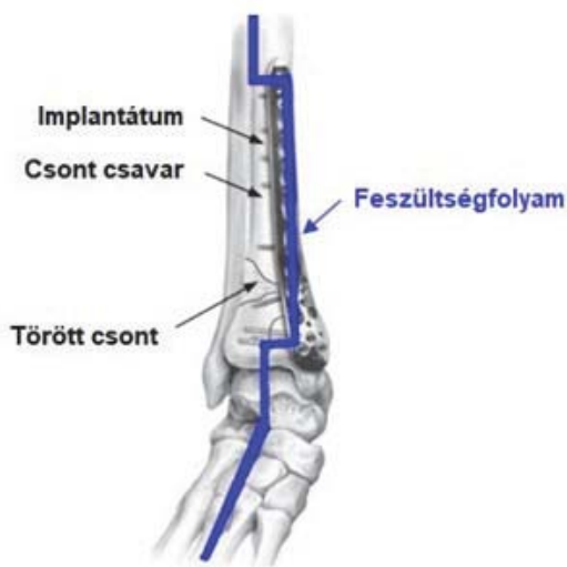
3. ábra. Feszültség átterhelődés a csonttól az implantátumra [8]
