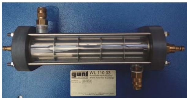
2. ábra: A vizsgált modell hőcserélő
