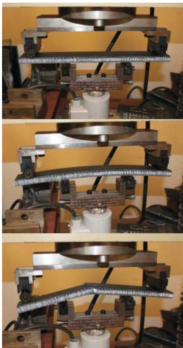
2. ábra - Próbatest konfiguráció a hajlítási teszthez
