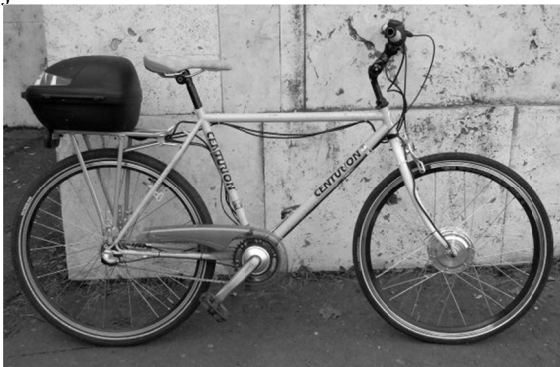
1. ábra: A kísérletben használt egyik ember-elektromos hibrid. A 250 wattos motor az első kerékagyba van beépítve, az akkumulátor a csomagtartó dobozban található.
