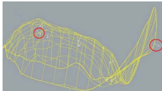
7. ábra: A vápa határait meghatároztuk, a felület normálisának irányjai a piros körökkel vannak jelölve.
