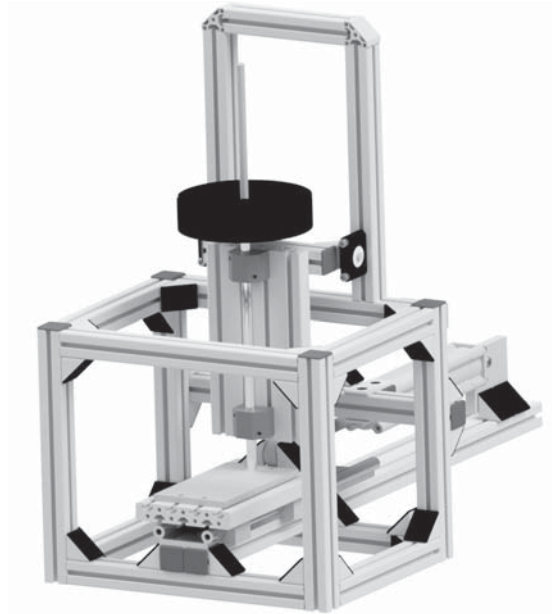
3. ábra. A koptatáshoz használt berendezés
