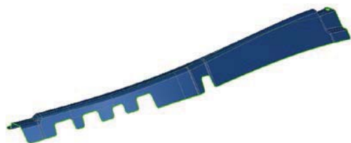
9. ábra. A-oszlop merevítő elem geometriája
