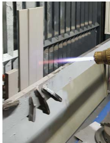
2. ábra A Niborit 6-P por felszórása nagysebességű láng-porszórással
