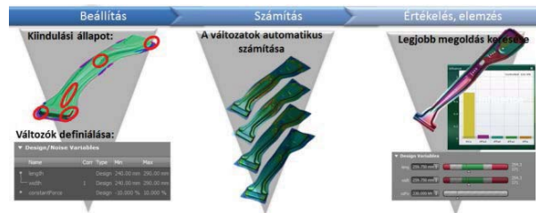
1. ábra. Az AutoForm SPI logikai felépítése
