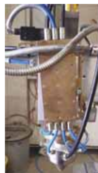
4. ábra. A porszóráshoz használt lézeres megmunkálófej fotója
