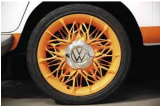
2. ábra - Generatív tervezéssel meghatározott kialakítású felni [2]
