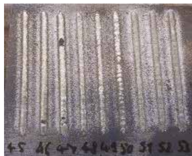
14. ábra. A lézeres bevonati sávok fotója 11 mm-es defókusznál különböző lézer teljesítmények és portömegáramok esetén
