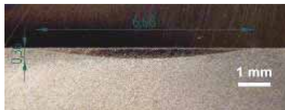
8. ábra. Lézerrel edzett sáv keresztmetszeti csiszolata ( P=3000\text{ W} , v=2,5\text{ m/perc} )
