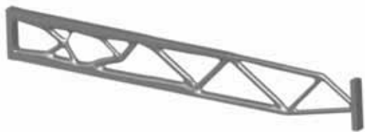
6. ábra. Generatív design után kapott geometria
