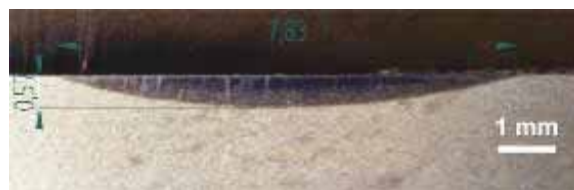
9. ábra. Lézersugárral edzett sáv keresztmetszeti csiszolata ( P=3000\text{ W} , v=2\text{ m/perc} )
