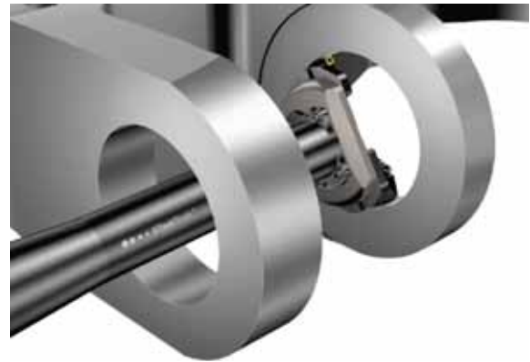
3. ábra. Moduláris szerszámcsatlakozások esztergálási műveletekhez [4].
