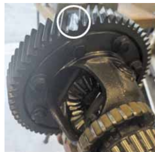
1. ábra Lemunkált fog a végáttétel kihajtó fogaskerekéről
