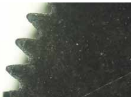
18. ábra. A z=94 , m=0,3 mm SLA nyomtatással létrehozott fogaskerék legfelső rétegének 25x nagyítású mikroszkópos képe
