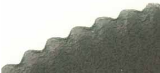
17. ábra. A z=94 , m=0,3 mm SLA nyomtatással létrehozott fogaskerék legalsó rétegének 25x nagyítású mikroszkópos képe
