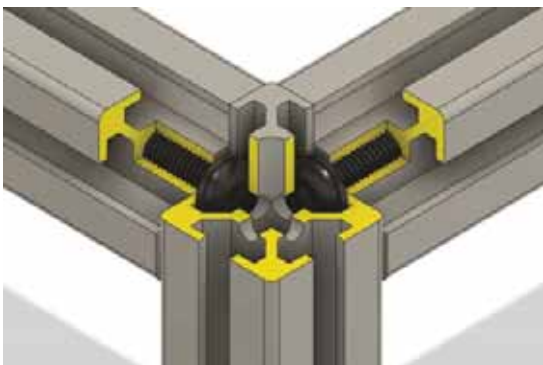
9. ábra: Alumíniumprofilok egymáshoz rögzítése D-fejű csavarral
