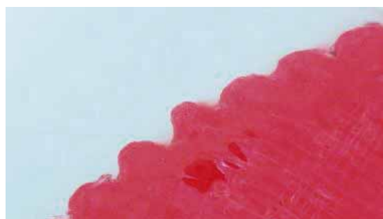
8. ábra. A z=94 , m=0,3 mm FDM nyomtatással létrehozott fogaskerék legalsó rétegének 25x nagyítású mikroszkópos képe
