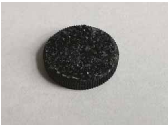
23. ábra. A támaszok eltávolítása után kapott fogaskerék
