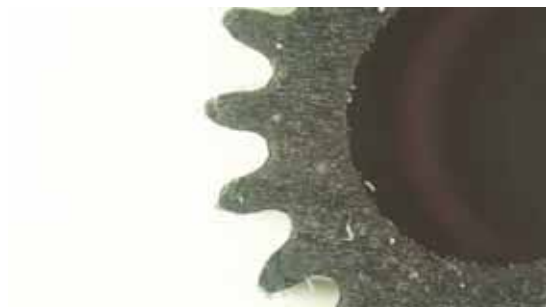
28. ábra. A z=19 , m=0,3 mm SLA nyomtatással létrehozott agyas fogaskerék legfelső rétegének 25x nagyítású mikroszkópos képe
