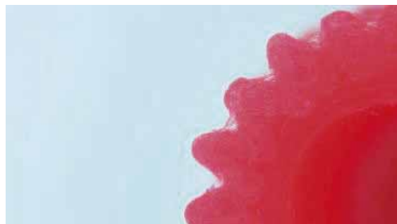
6. ábra. A z=19 , m=0,3 mm FDM nyomtatással létrehozott fogaskerék legalsó rétegének 25x nagyítású mikroszkópos képe
