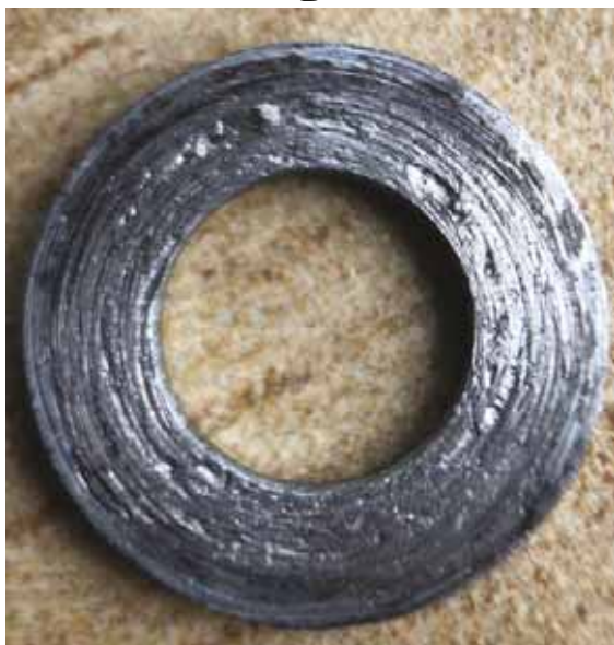
7. ábra.: A csavarszár felületi hibái (A), a csavaranya felülete (B) az alátét felülete (C) a többszöri alkalmazást követően.
