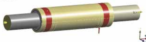
4. ábra. A kompozit tömlődarab terhelései és peremfeltételei a végeeselemes makromodellben
