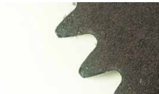
32. ábra. A z=50 , m=0,5 mm SLA nyomtatással létrehozott agyas fogaskerék legfelső rétegének 25x nagyítású mikroszkópos képe
