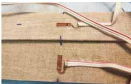
2. ábra. A húzó próbatetek terhelés előtt
