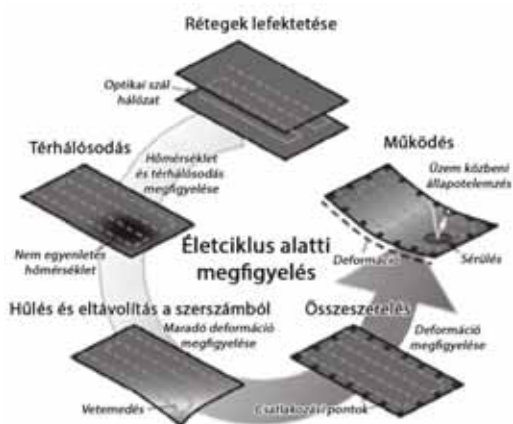
5. ábra Életciklus alatti elemzés beépített optikai szállal [15]
