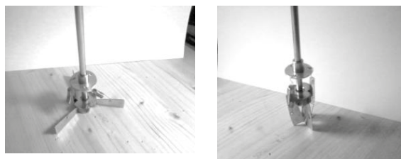
5. ábra Rugós keverő nyitott és zárt állapotban [4]
