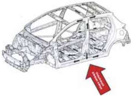
3. ábra: Oldalirányú ütközés esetén az energia útja [14]
