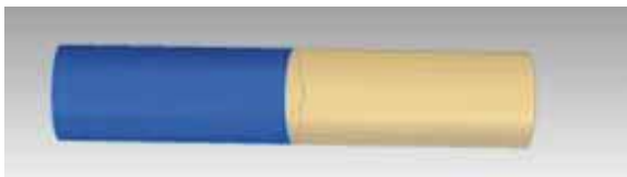
6. ábra. Azonos méretű, de eltérő felületi érdességgel rendelkező felületek színekkel történő ábrázolása 3D CAD modellek esetén
