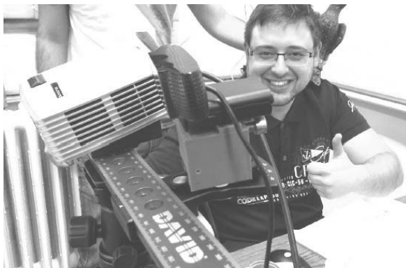
6. ábra Egyedi SLS elvű szkennelő eszköz a David szoftver, Acer K132 projektor és Logitech c920 webkamera alkalmazásával (Szalóczy Döme László)
