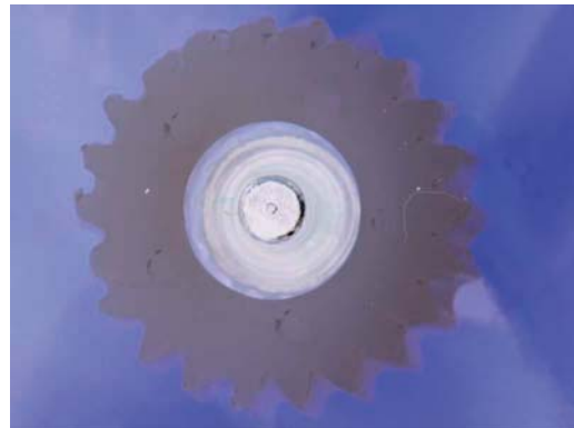
3. ábra: fogaskerék károsodása visszaforgatáskor (20x nagyítás)
