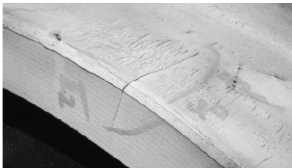
10. ábra. Termikus mikrorepedések a kerék felületén és a kerék oldalára is kiterjedt fáradásból adódó repedés [10]
