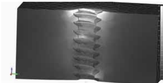
9. ábra. Feszültség eloszlás csontban, csak előfeszítéssel terhelve
