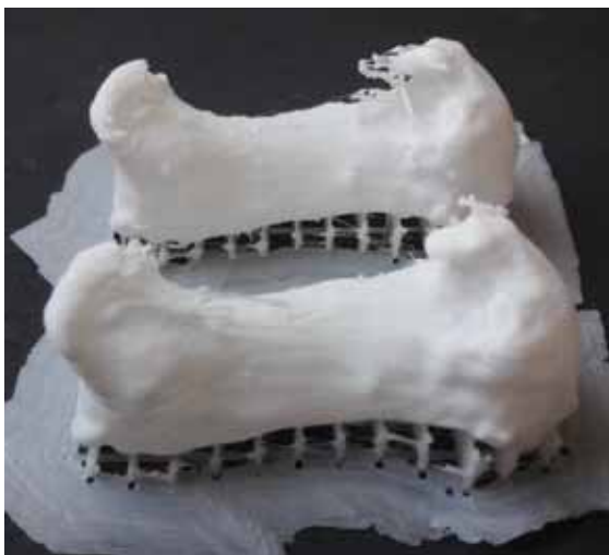
10. ábra. Az eredeti és az egyszerűsített geometria a nyomtatás után
